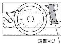
プラスドライバーで調整ネジを回すことで高さ調整可能です。(上下 5mm 調整可能)
