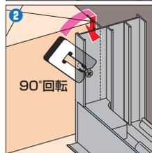
スペーサーの向きを90°回転しながらビスをはさみ込みます。そのまま取付ビスに突き当たるまで下側へ引き落とします。
