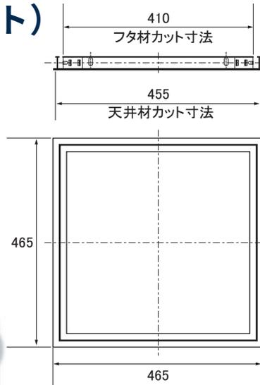
材質 (仕上) アルミ押出し (アルマイト+塗装)
