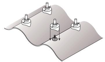
補修の場合、ボルトが錆びて細くなってサイズが合わない場合はコーキング剤を使用してください。
