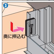
サッシ面よりスペーサーが突き出ている分をそのまま奥へ押し込みます。サッシ枠の取付状態を確認した後、仮止めしてあるサッシ取付ビスをすべて締め付けて、施工を完了します。
