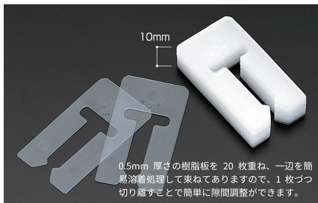
0.5mm厚さの樹脂板を20枚重ね、一边を簡易溶着処理して束ねてありますので、1枚ずつ切り離すことで簡単に隙間調整ができます。
