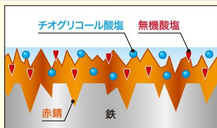
チオグリコール酸塩がすばやく浸透しサビを瞬時に分解します。また、無機酸塩がサビを細分化することでチオグリコール酸塩の分解性能をより高めます。
