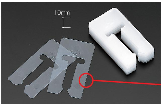
0.5mm厚さの樹脂板を20枚重ね、一辺を簡易溶着処理して束ねてありますので、1枚ずつ切り離すことで簡単に隙間調整ができます。
