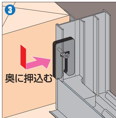
サッシ面よりスペーサーが突き出ている分をそのまま奥へ押し込みます。サッシ枠の取付け状態を確認した後、仮止めしてあるサッシ取付けビスをすべて締め付けて、施工を完了します。
