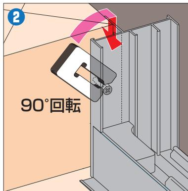
スペーサーの向きを90°回転しながらビスをはさみ込みます。そのまま取付けビスに突き当たるまで下側へ引き落とします。
