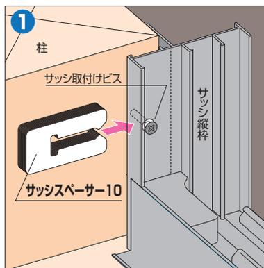
サッシ取付けビスを狙ってスペーサーを隙間に挿入します。
