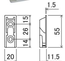
【材 質】ブラケット:ABS樹脂(クロームメッキ仕上) / リング:ステンレス(研磨仕上)
