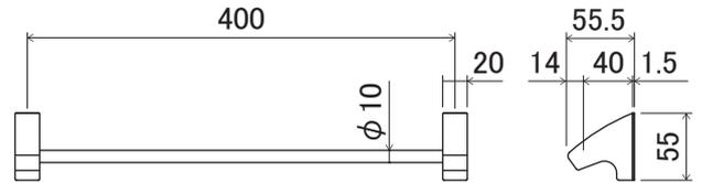
【材 質】ブラケット:ABS樹脂(クロームメッキ仕上) / バー:ステンレス(研磨仕上)
