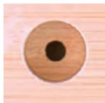
10mm 径の 段掘り穴
