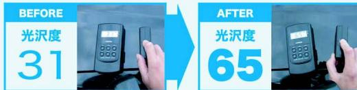
グロスチェッカー……物の表面に光を当てた時の反射の程度を示す光沢度を計測します。
