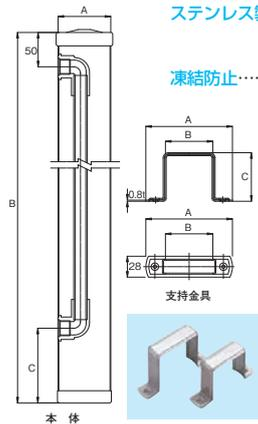
**ステンレス製**…ステンレス製ヘアライン仕上げで、高級感にあふれています。コンクリート製や塩ビ製水栓柱に比べ抜群の強度です。
