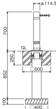
●キャブのないシンプルな外観。補強バーの装着により、柱の沈み込みを防ぎます。クサリ内蔵タイプは静音設計(一部商品省く)。
