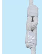
ロープはポリエステル繊維(テトロン)太さφ8金剛打ちです。ロープの長さは(高さ×2-1)mがセットされています。但し、13m以上は(高さ×2+1)mがセットされます。
