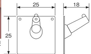
●時計に最適なフックです。石コウボード、板壁に時計をピタッと取り付けできます。
