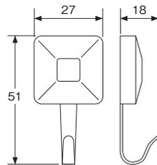
●コンクリートはもちろん、タイル、石コウボード、板壁にも使えます。ネジ止・ピン止兼用。
