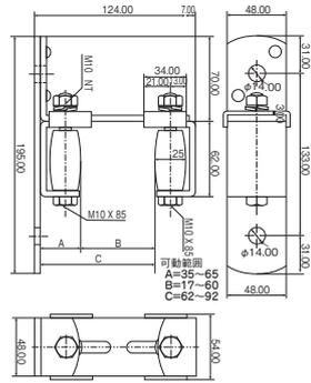
●取り付けは溶接、ビス止めのいずれでも可能です。門扉の厚みは60mmまで適応可能。ローラーに含油ジュラコン樹脂を用いているので軽快に作動します。内・外両側のローラー調整が出来ます。
