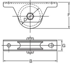
●MCナイロン車の使用により、ゴム車輪車に比べ耐荷重・磨耗性に優れ、また鉄製車輪に比べ防音効果に優れています。
