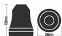
ゴム底は特殊溝形状 設置面が少し斜めでもOK
