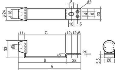
材質 ステンレスSUS-304 使用ビス径 +皿 2.7×16付属
