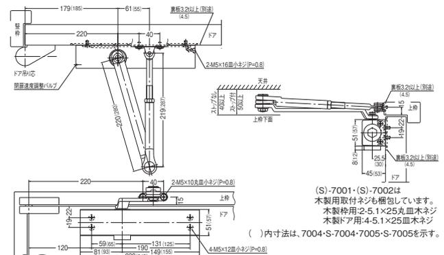
(S)-7001・(S)-7002は木製用取付ネジも梱包しています。木製枠用:2.5.1×25丸木ネジ 木製ドア用:4.5.1×25皿木ネジ
