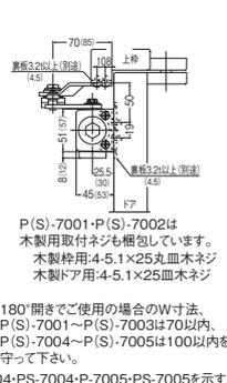
P(S)-7001・P(S)-7002は木製用取付ネジも梱包しています。木製枠用:4.5.1×25丸木ネジ 木製ドア用:4.5.1×25皿木ネジ
