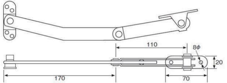
【材質】ステンレスSUS304 【仕上】バレル研磨
