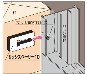
サッシ取付ビスを組んでスペーサーを隙間に挿入します。
