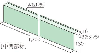
施工する際は、中央部の溝に沿って、手で2つに裂きます。
