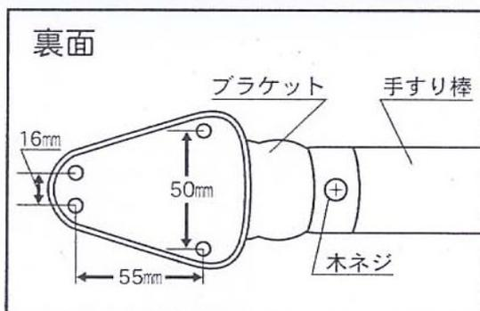
ブラケット裏側の木ネジをゆるめ、手すり棒をはずして、適当な長さにカットすることで長さ調節もできます。
